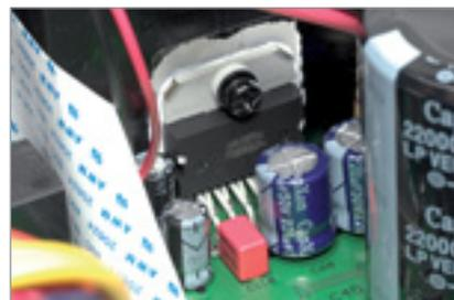
Integrierte MOSFET-Endstufenschaltungen sparen Platz
